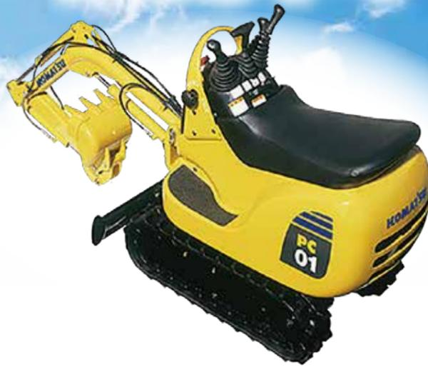
■機械質量……300kg ■バケット容量……0.008m<sup>3</sup>
