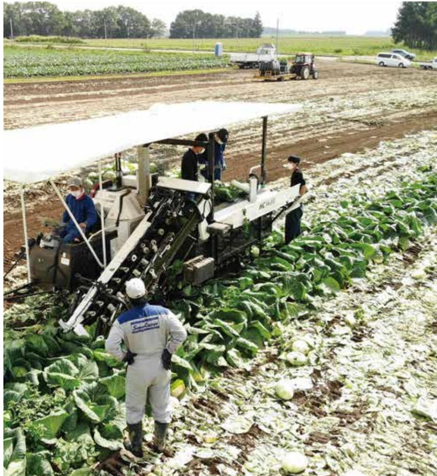
最少人数で効率的に収穫して運搬する「キャベツ自動収穫システム」（9月、鹿追町）=JA鹿追町提供
