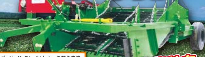
石寄せ機ストーンディガーは、ストーンピッカーの前作業機で、片道又は往復で一列に石礫を堆石させる機械です。その後を、ストーンピッカーで堆石した石礫を拾い上げるだけです。除礫作業を早く終わらせることができます。
