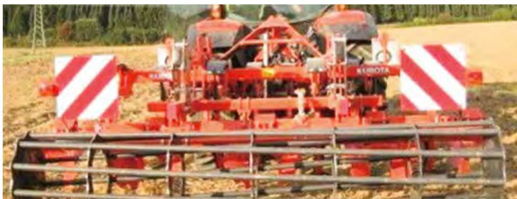
走行できるようにした農作業機付きのトラクター
