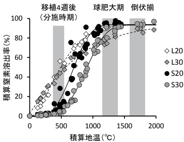
図1 施肥後耕耘日からの積算地温と被覆尿素肥料の積算窒素溶出率との関係 (北見農試・現地 2019~2021年)
