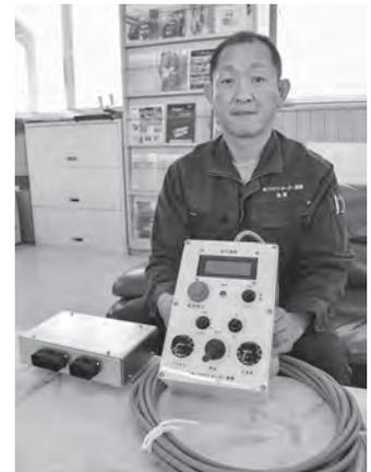
フクザワ・オーダー農機が開発した緊急停止装置
