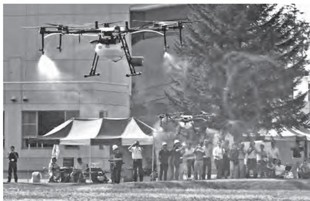
2機のドローンを編隊飛行させて行われた農薬散布テスト
