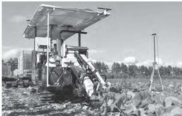
キャベツ畑を無人で走る収穫機。画像やレーダーなどの計測装置、AIを用いて自動で収穫する
