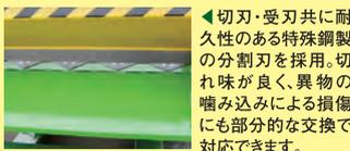
◀切刃・受刃共に耐久性のある特殊鋼製の分割刃を採用。切れ味が良く、異物の噛み込みによる損傷にも部分的な交換で対応できます。
