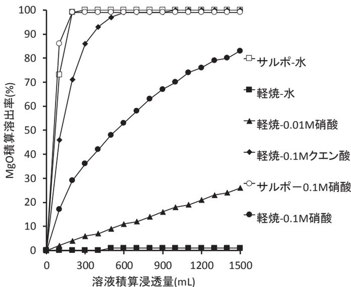
図1 サルポマグおよび軽焼マグネシウムからのマグネシウム積算溶出率
